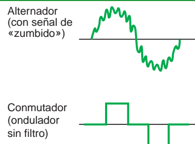
Fig. 24: Ejemplo de onda de tensión entregada por generadores «baratos».
